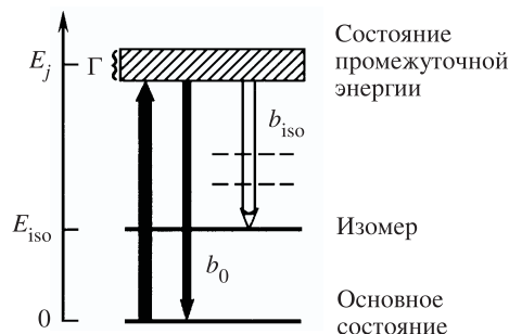
Рис. 7. Схематическое представление резонансного механизма, в котором изомер с энергией E_{\text{iso}} заселяется через состояния при промежуточной энергии (заштрихованная область). Промежуточные состояния характеризуются энергией возбуждения E_j и шириной распада \Gamma . Парциальные ширины b_0 и b_{\text{iso}} описывают распад промежуточного состояния, соответственно, в основное состояние и на изомер. Величина b_{\text{iso}} является суммой всех неизвестных каскадов, посредством которых промежуточное состояние распадается на изомер через уровни, обозначенные пунктиром
