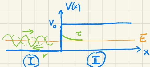
Fall  $0 < E < V_0$ : Energien unterhalb der Potentialstufe  $E = \frac{\hbar^2}{2m} k^2$
